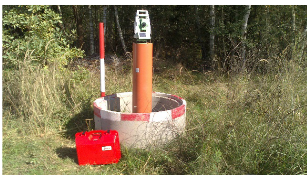
Způsob provedení bodu Mikrosítě pažnice
